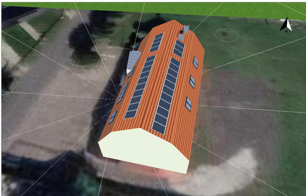
Ilustracja 1. Rozłożenie modułów fotowoltaicznych na dachu budynku – widok 3D
